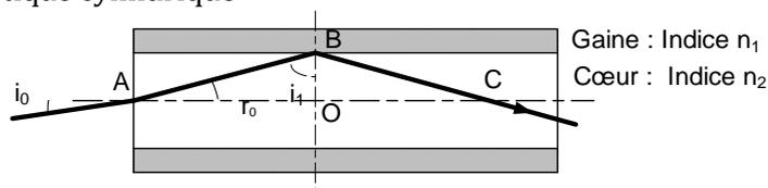
Un rayon incident se propage dans l'air dans un plan axial à la fibre et arrive en A sous un angle d'incidence  $i_0$ . La réfraction est définie par la relation de Descartes :  $n_0 \sin(i_0) = n_2 \sin(r_0)$ .
