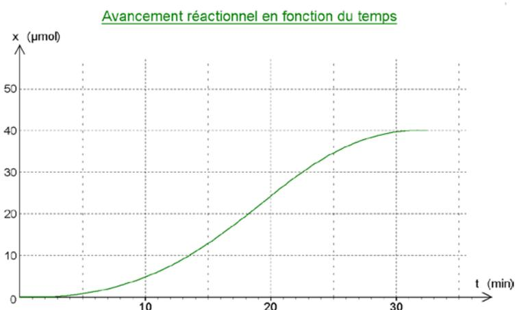
Dans un réacteur thermostaté, on introduit 100,0 mL de la solution de permanganate de potassium de concentration  $1,00 \times 10^{-3} \text{ mol.L}^{-1}$ , à 100,0 mL d'une solution d'acide oxalique de concentration inconnue. La réaction commence alors entre l'acide oxalique et l'ion permanganate ; cette réaction est totale :
